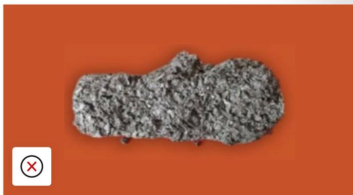
Capteur TPMS contaminé par un produit d'étanchéité
