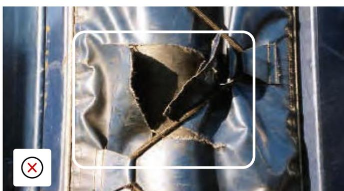
Entailles non-réparées dans le rideau au niveau des coins ou des poteaux de tension.
