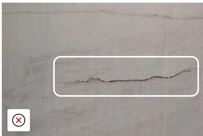
Sur un panneau latéral en stratifié de fibres de verre, une fissure avec infiltration d'eau, de fines fissures indiquent un impact intérieur.
