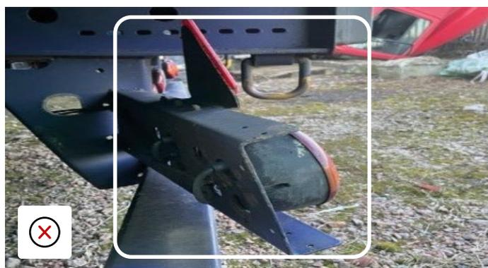
Support de feu arrière plié et nécessitant une réparation
