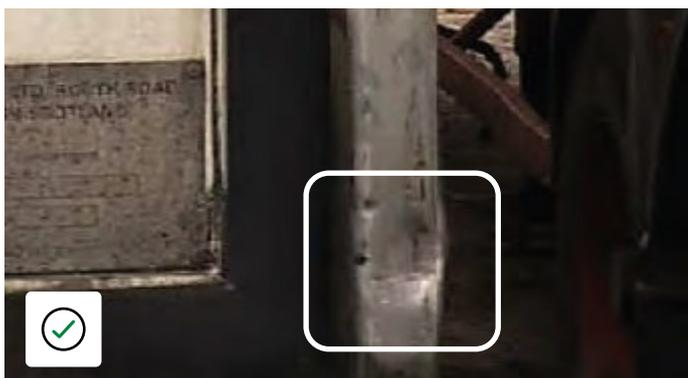
Support de charnière de porte arrière tordu suite à une collision; ne gêne pas la manipulation de la porte.
