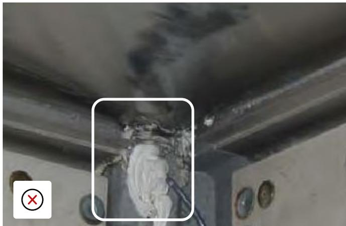
Dommmages sur la tôle de toit avant et sur le boîtier du feu de position. Autres dommages sur la têtère avant, le poteau d'angle, le rail supérieur droit et les panneaux.
