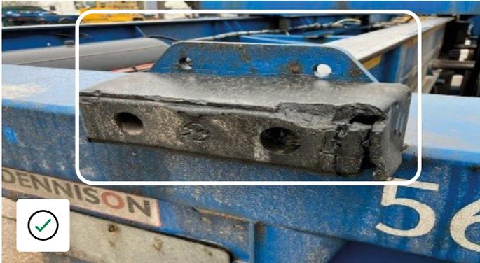
Usure normale du butoir de protection en caoutchouc, pas de répercussion sur le client à condition qu'il n'y ait pas de dommage sur la zone de la remorque censée être protégée par le pare-choc.
