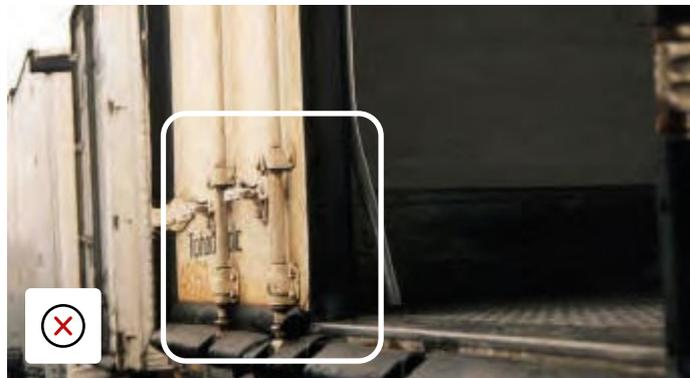
Garniture aluminium des joints de porte endommagée.
