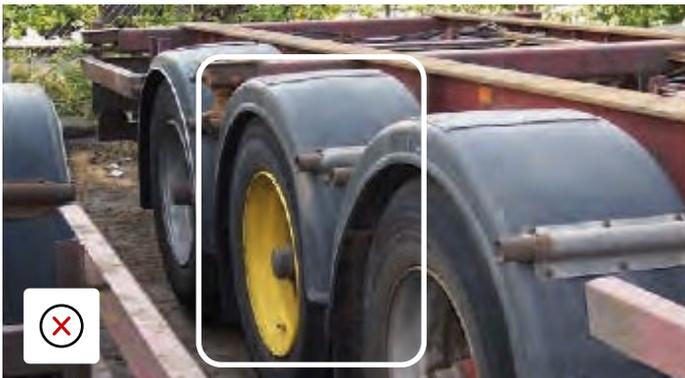
Roue de mauvaise couleur et ailes raccordées; dommages éventuellement dus à une surcharge ou à une utilisation à une mauvaise hauteur de suspension.
