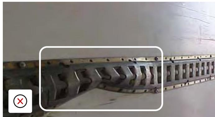
Détérioration irréparable du dispositif d'arrimage de la charge.
