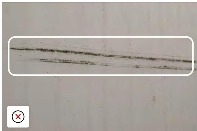
Sur un panneau latéral en stratifié de fibres de verre, éraflure avec revêtement Gelcoat cassé, infiltration d'eau et de la moisissure.
