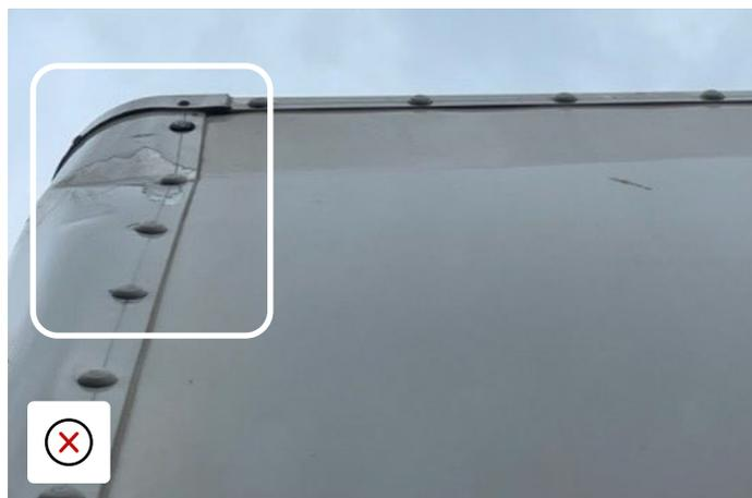
Poteau d'angle endommagé suite à une collision, avec absence superficielle de peinture.
