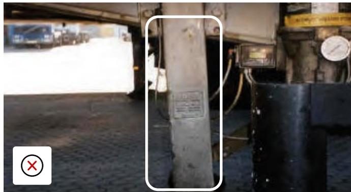
Béquille tordue, pas de répercussion sur le client si la différence ne dépasse pas 10 % de l'angle à 90°. Répercussion sur le client en cas de dépassement de ladite limite ou si la déformation affecte la fonctionnalité.
