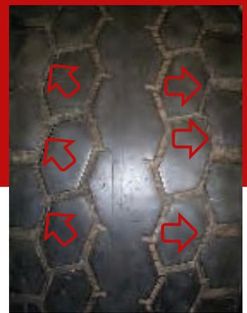
Fissuration des rainures de la bande de roulement en raison d'un gonflage excessif
