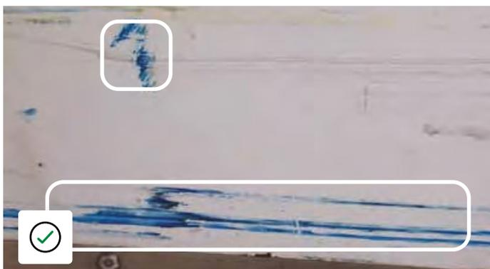
Eraflures du panneau en stratifié de fibres de verre sans perforation du Gelcoat.
