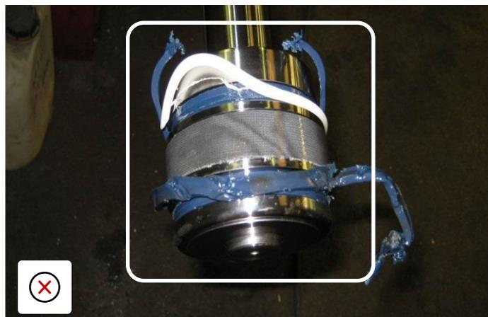
Raccords hydrauliques endommagés à la suite d'une mauvaise utilisation ou d'un choc
