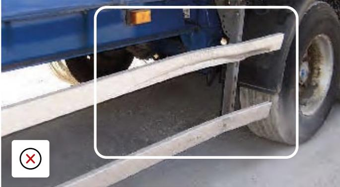
Cabossages et déformation des protections latérales en aluminium en raison d'un impact.
