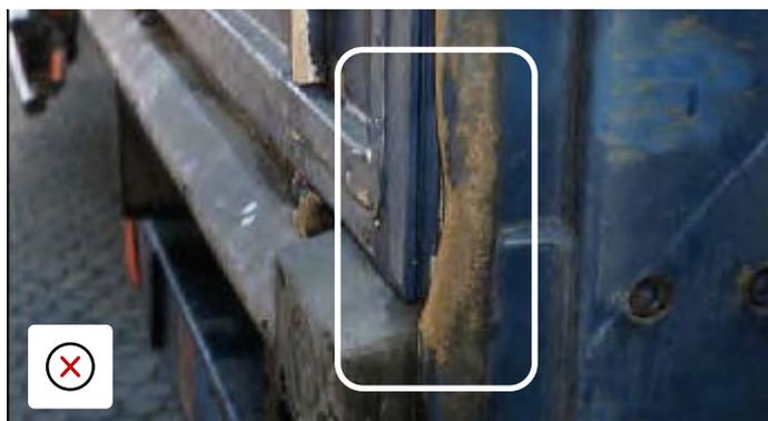
Support de charnière de porte arrière tordu suite à une collision; gêne la manipulation de la porte.
