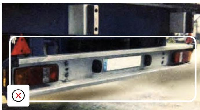
Barre anti-encastrement tordue, pas de répercussion sur le client si la différence ne dépasse pas 10 % de l'angle à 90°. Répercussion sur le client en cas de dépassement de ladite limite et également si les inspections réglementaires exigent la réparation (MOT, etc.).
