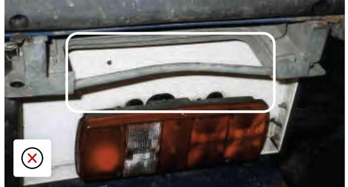
Echelle d'accès arrière restituée en mauvais état.
