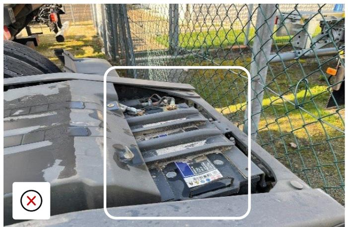
Couvercle de batterie manquant - exposant la batterie aux éléments
