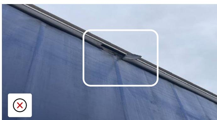
Élément déchiré à la suite d'un impact - permet l'infiltration d'eau.
