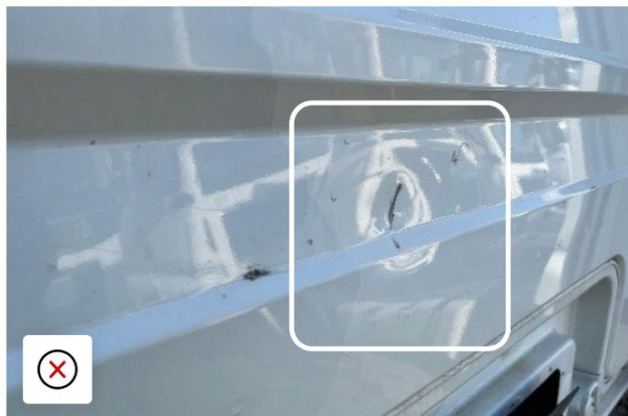
Dommages causés par un choc à l'arrière de la cabine, provoquant une fissure
