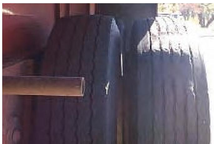
Pneus jumelés de diamètre différent ou inadaptés.
