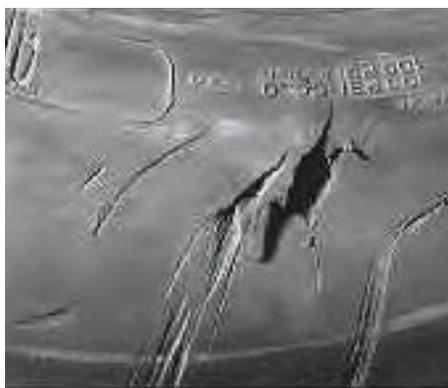
Domages causés au pneu par une pénétration profonde dans le flanc.
