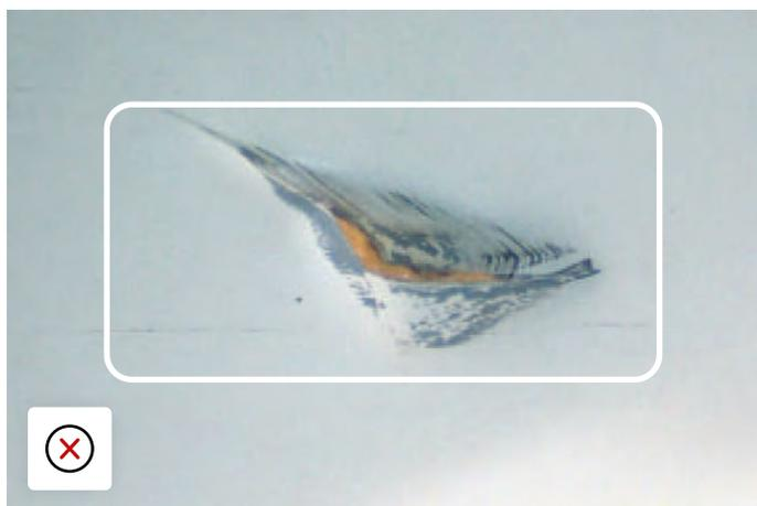
Panneau Ferroplast entaillé avec la surface extérieure percée, exposant ainsi l'isolation à l'eau et aux contaminants.
