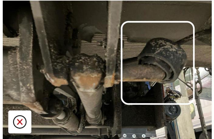
Roulette de plateau cassée à cause d'un impact - nécessite un remplacement
