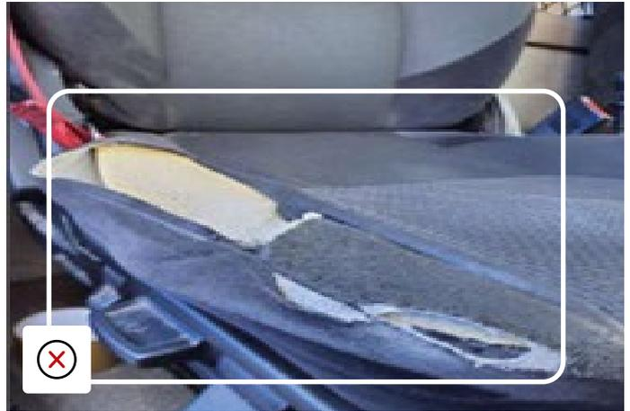
Déchirures sur la housse du siège exposant le rembourrage en mousse
